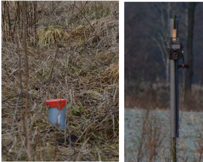
Abb. 45: Bodenhülse (links, Foto: Wix, 17.02.2103) und Befestigung und Sicherung der Kamera an Metallstange mit Styropor-Keil (gelb) (rechts, Foto: Wix, 12.01.2103)
