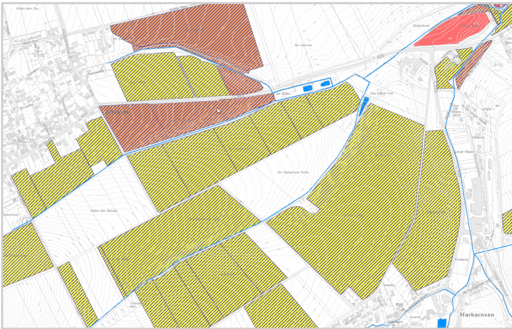
Abb. 7: Kartenausschnitt vom Nibis®-Kartenserver zu den Abstandsvorgaben gemäß § 5 Abs. 3 DüV 2020 und Vorgaben gemäß § 38a WHG
