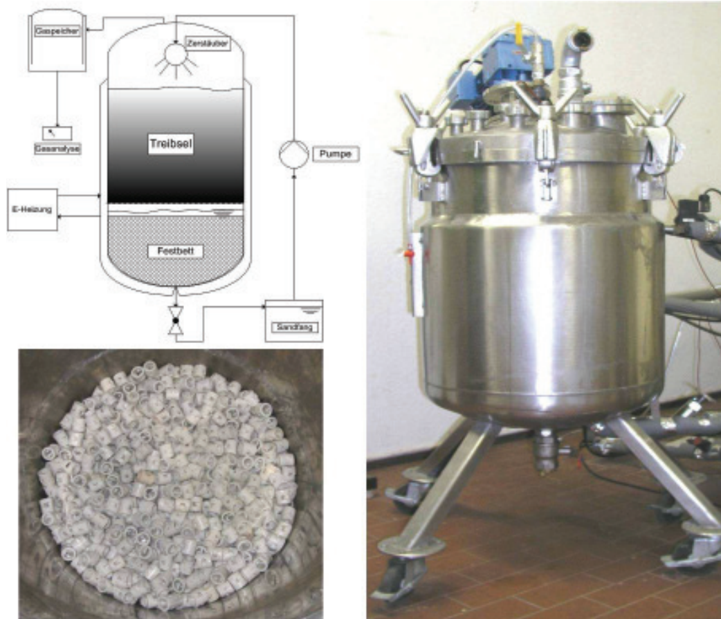
Abbildung 12: Links oben: Verfahrensfliessbild Festbett-Feststoff-Fermenter. Links unten: Festbett. Rechts: 100-L-Festbett-Feststoff-Fermenter an der HAWK Göttingen
