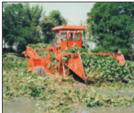
Abbildung 19: Rückschnitt des Uferbewuchses mit Spezialboot „Aquamarine Aquatic Harvester“ in den USA (AQUAMARINE, 2009, S. 3)
