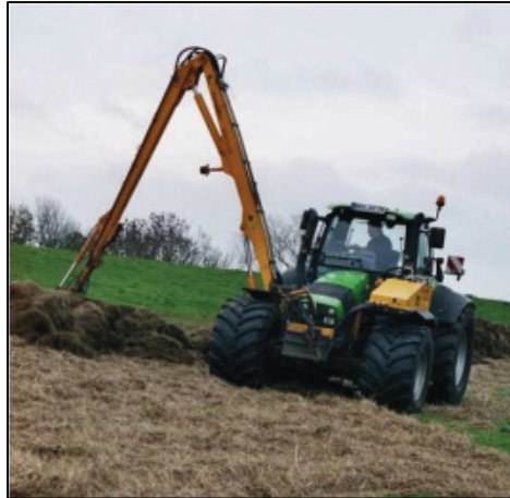
Abbildung 22: Schlepper mit Spezialanbau bei der Treibselbergung (CORNELIUS & WILKEN, 2009, pers. Mitteilung)
