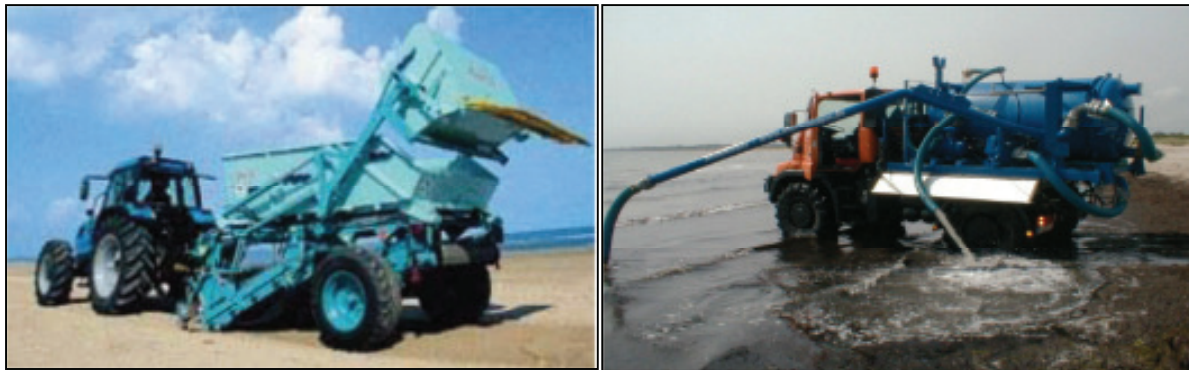
Abbildung 17: links: Beach-Cleaner der Firma Kässbohrer; rechts: Sea-Cleaner Algensauger der Firma Land & Bau Kommunalgeräte (ECKSTÄDT, 2009, S. 18)
