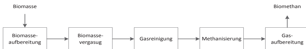
Abb. 2-3: Schematische Darstellung der Biomethan-Erzeugung durch thermochemische Umwandlung
